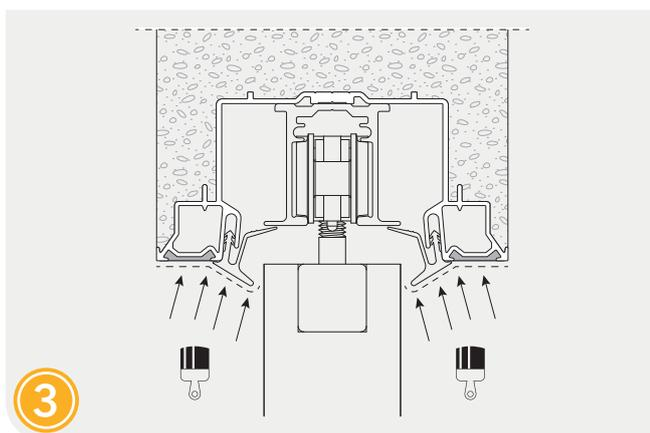
Togliere la protezione della traversa e installare la guarnizione. Pitturare poi la guarnizione orizzontale.
