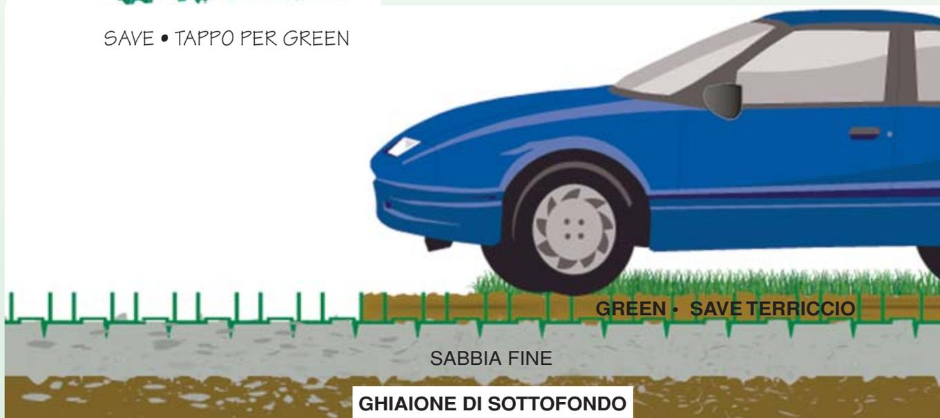
Viene prodotto in **POLIETILENE AD ALTA DENSITÀ STABILIZZATO U.V.** per mantenere inalterate le caratteristiche meccaniche e di colore alla esposizione dei raggi U.V.
