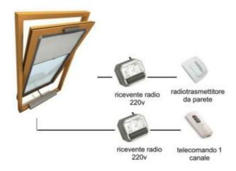
Dati tecnici ricevente: Tensione nominale 230-240v AC/50Hz
