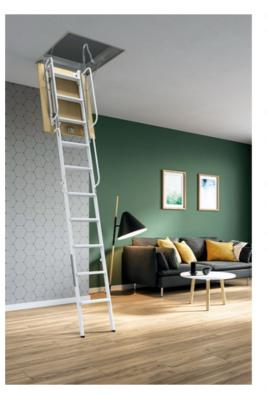
Scala retrattile per soffitta con struttura rigida a 4 parti mobili composta da 10 gradini in lamiera stampata 15/10 e verniciata bianco (RAL 9010) e struttura mobile costruita in tubolare d'acciaio (50 x 20 mm) e molle ammortizzatrici e di richiamo per facilitare l'apertura e la chiusura della scala.
